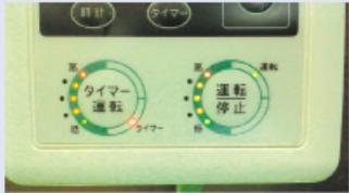
①ブレーカーを「入」にすると、コントローラの全てのランプが点滅しますので何かのキーを押す。
