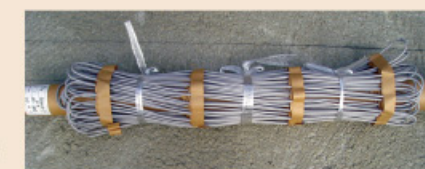
敷設前のヒータです
